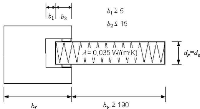
Figura 1. Sección del perfil con panel aislante.
